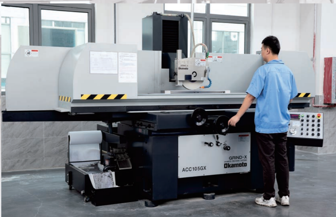
OKAMOTO 冈本平面磨床 ACC105GX 工作台行程: 1150*540
